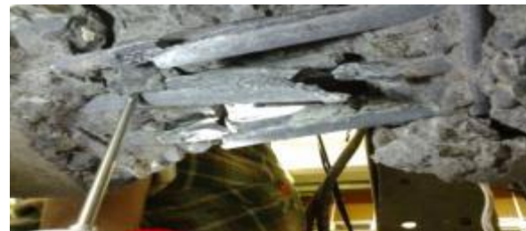
(d) Typical reinforcement failure
